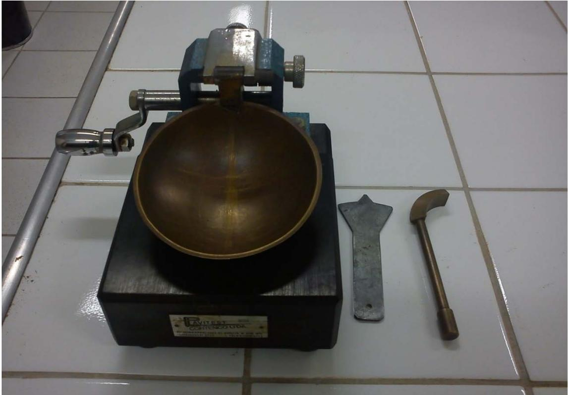
Aparelho de Casagrande, Cinzeis Arenoso e Argiloso.
