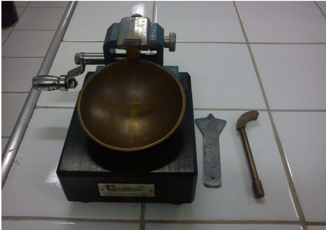
Figura 1: Aparelho de Casagrande, Cinzeis Arenoso e Argiloso.
